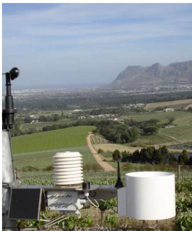
L'acquisition, le stockage et le transfert des données se font automatiquement. Les données sont transférées par GPRS vers le serveur [www.fieldclimate.com](http://www.fieldclimate.com) où l'exploitant de la station peut les consulter de n'importe quel endroit de la planète via un accès Internet.
